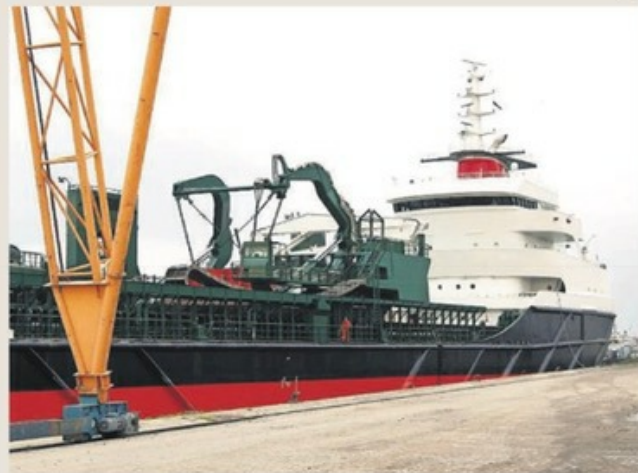
Der hydraulische Schallengreifer der M/V Spauwer kann bis zu 3000 Tonnen Kies pro Stunde aus dem Schiffbauch holen und aufs Transportband setzen.
