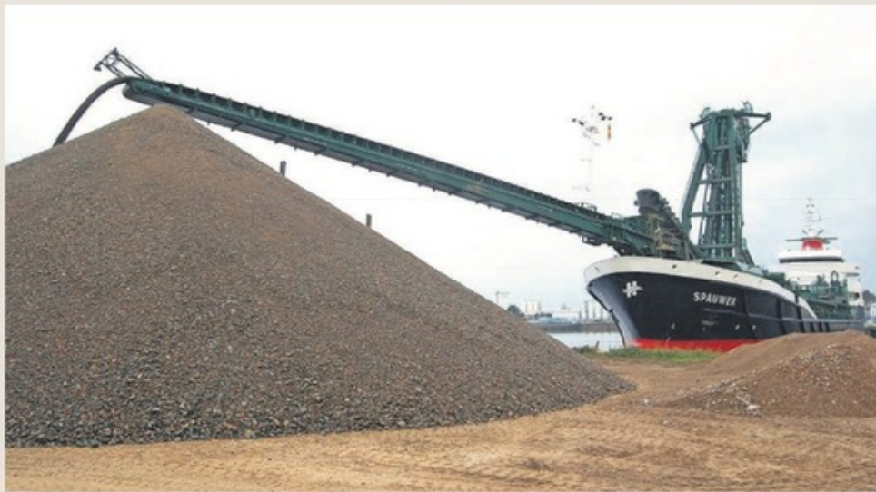
Ein Förderband transportiert den Seekies vom Schiff aufs Land. Die Ware wurde bereits an Bord Offshore gesiebt, gewaschen und fast vollständig entwässert (vakuumisiert). Fotos: Meisner
